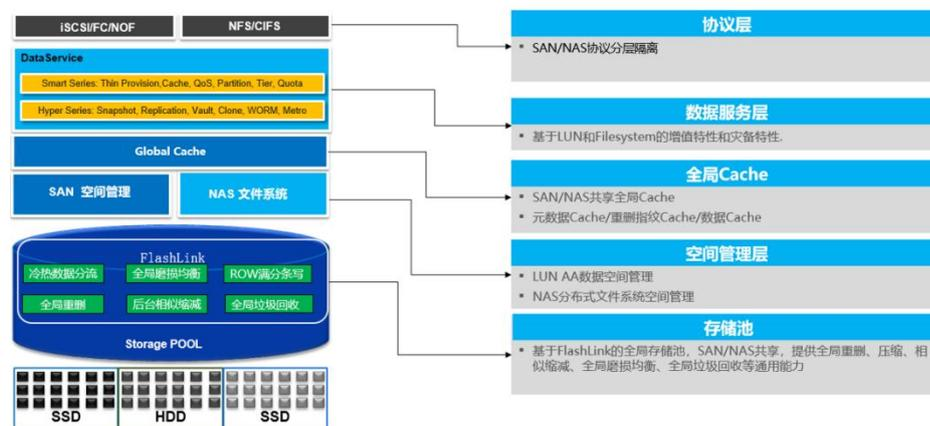
FastCube 混合闪存的系统架构自下而上包括以下子系统：
